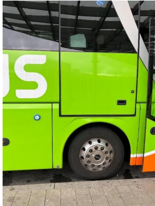
Bild FS04- 7: Schlagtür mit Hublift für den Zugang von Menschen im Rollstuhl an einem Fernlinienbus (Foto: Boenke)
