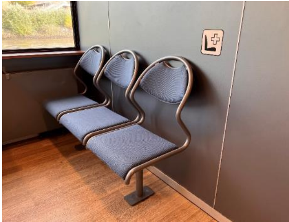
Bild FS19- 6: Kennzeichnung der Sitzplätze für Menschen mit Mobilitätseinschränkungen
