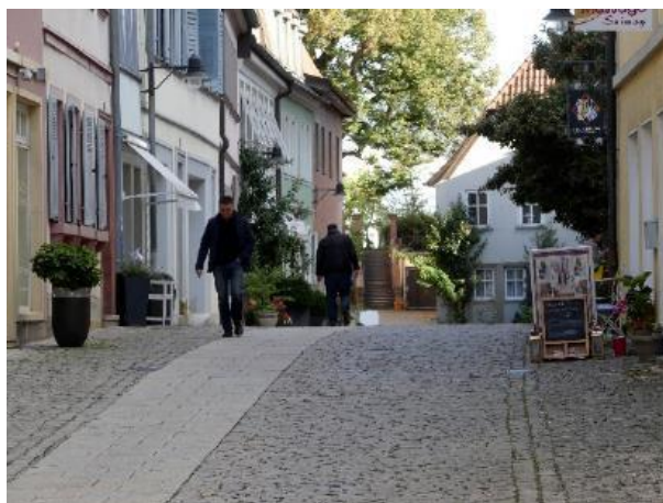
Bild FS01- 1: Nutzung der nachgerüsteten Pflasterbänder durch den Fußverkehr (Foto: Boenke)
