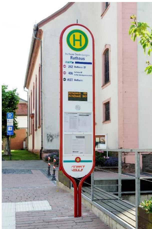
Bild FS14- 4: Dynamischer Fahrgastinformationsanzeiger im Zwei-Sinne-Prinzip, integriert in das Haltestellenschild (Foto: MTV)
