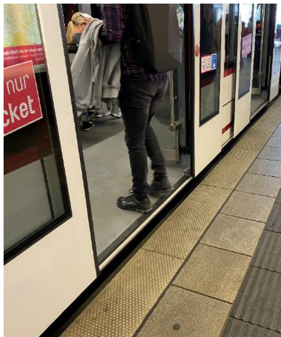
Bild FS02- 11: Niveaugleicher Fahrgastwechsel in die Straßenbahn an der ÖPNV-Haltestelle (Foto: Eichmann)
