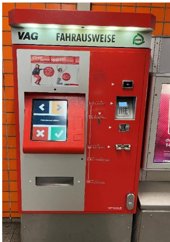
Bild FS17- 2: Fahrausweisautomat mit taktil, visuell und akustisch unterstützter Menüführung (Foto: Lutz)
