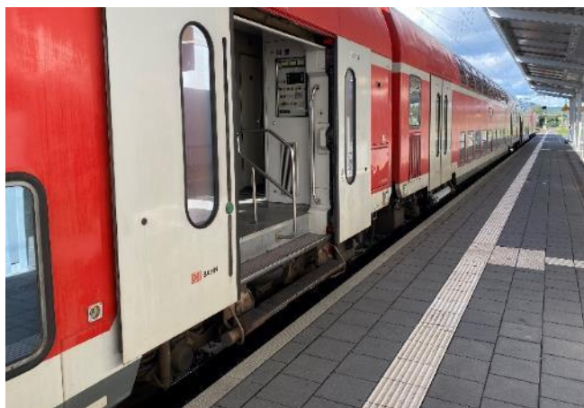
Bild FS09- 3: Nicht barrierefreier Zustieg zum Regionalverkehr (Foto: Eichmann)
