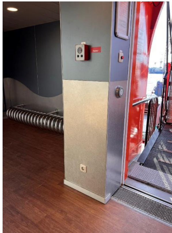
Bild FS19- 9: Verschiedene Kommunikationselemente (Taster); teilweise zu hoch montiert; nicht durchgängig großflächig; Funktion teils schwer erkennbar (Foto: Boenke)
