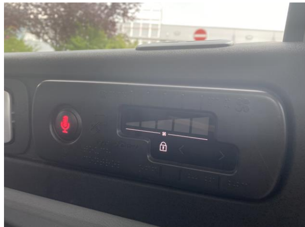
Bild FS10- 5: Sprechstelle zum Fahrer mit Braille-Beschriftung und visueller Rückmeldung (Foto: Eichmann)
