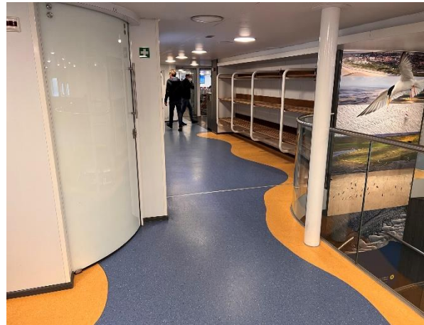
Bild FS03- 8: Visuell kontrastreiche Bodenmarkierungen im Fußbodenbereich der Fähre (Foto: Boenke)
