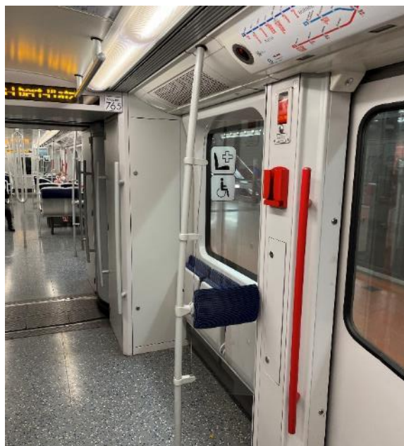
Bild FS17- 9: Fahrgastinnenraum der U3, Rollstuhlstellplatz und visuell kontrastierende Elemente (Foto: Lutz)
