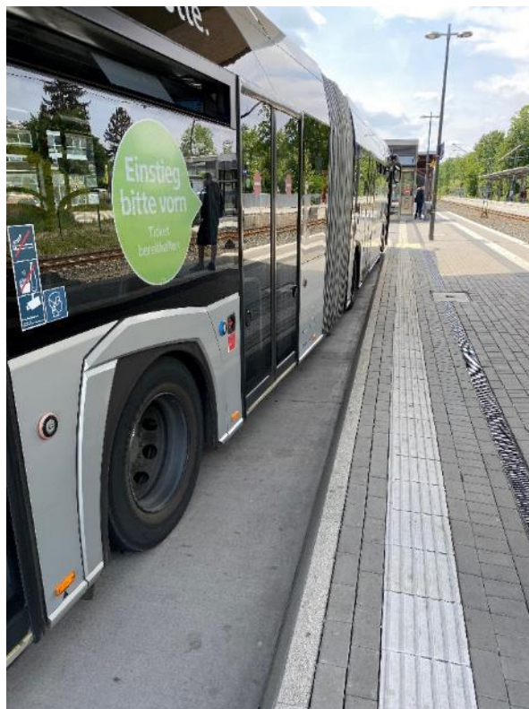
Bild FS06- 9: Keine parallele Anfahrt des Busses an den Bord (hier am Kombibahnsteig/Hausbahnsteig) (Foto: Lutz)
