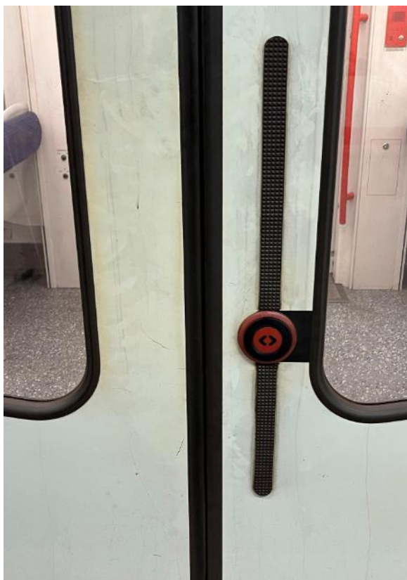
Bild FS17- 6: Taktile wahrnehmbarer Auffindestreifen zur Türöffnungstaste (Foto: Lutz)
