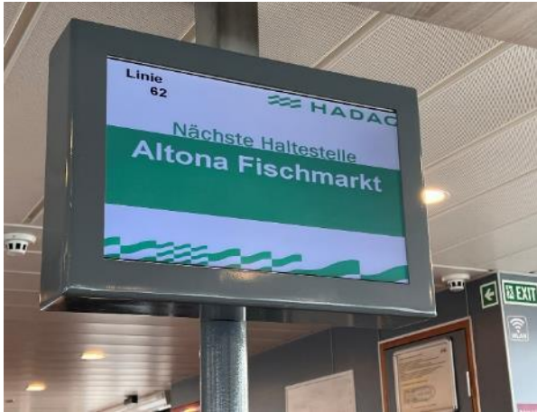
Bild FS19- 10: Fahrgastinformationssystem (Monitor) mit Haltestellenankündigung im Fahrgastraum auf dem Unterdeck (Foto: Boenke)
