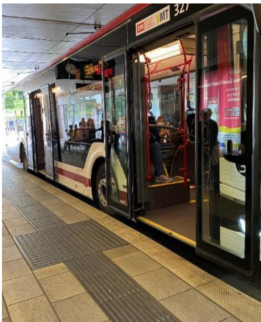
Bild FS02- 10: Umstieg zum Busverkehr mit Reststufe (Foto: Eichmann)
