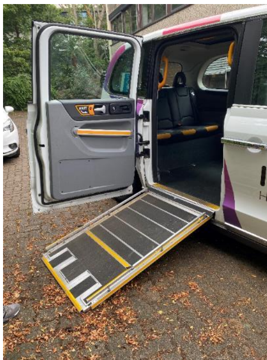
Bild FS10- 3: Ausgelegte Rampe (Foto: Eichmann)
