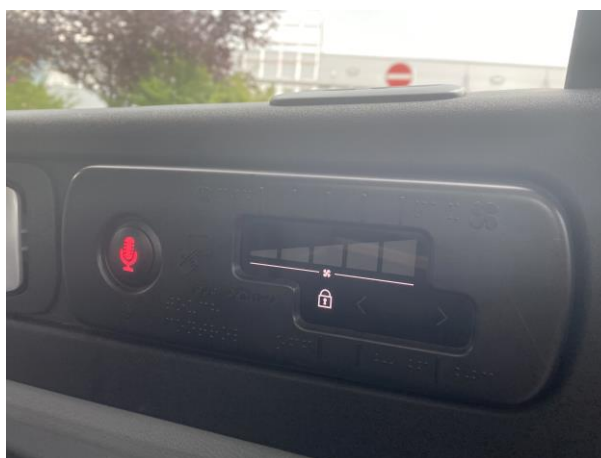
Bild FS10- 5: Sprechstelle zum Fahrer mit Braille-Beschriftung und visueller Rückmeldung (Foto: Eichmann)
