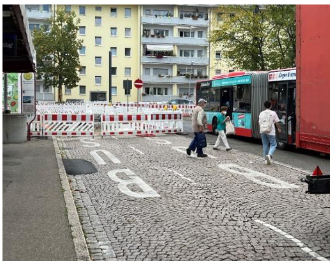
Bild FS15- 9: Bus an der SEV-Haltestelle Hornusstraße, links Asphaltkeil für stufenlose Wegeverbindung (Foto: Lutz)
