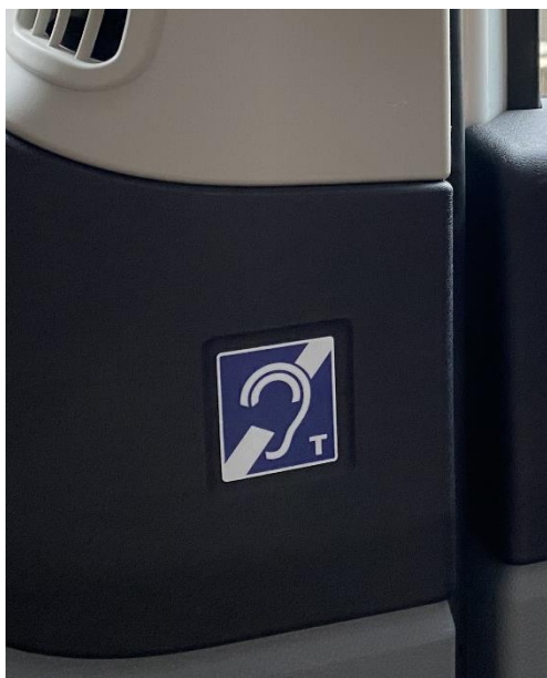
Bild FS10- 2: Hinweis auf induktive Höranlage (Foto: Eichmann)
