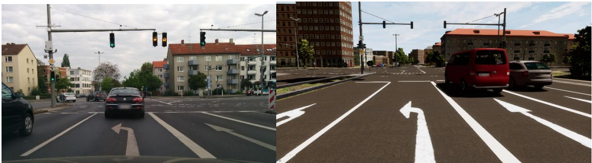
Abbildung 1: Vergleich der Simulation mittlerer Detaillierung mit realer Situation auf Visualisierungsebene
